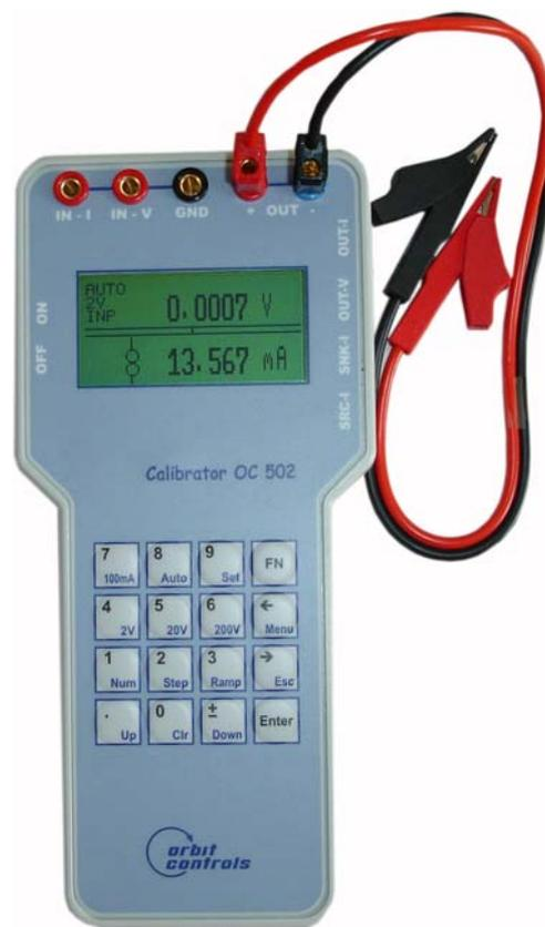
**Modell OC 502-V2** ist ein Kalibrator-Multimeter zum generieren von Strömen 0/4-20mA in Source- oder Sinkmode und Spannungen von 0-10V. Gleichzeitig können externe Spannungen in Bereichen ±2V, ±20V und ±200VDC (feste Bereiche oder automatische Bereichswahl) und Ströme bis ±100mA gemessen und am Display dargestellt werden. Der Kalibrator wird aus einer internen wiederaufladbaren Batterie versorgt und erlaubt einen 4 Std. Dauerbetrieb.
