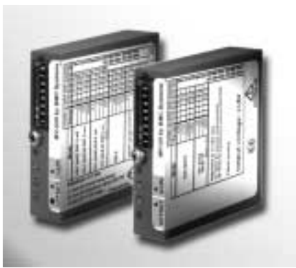
Galvanische Trennung auf allen Kanälen mit Standard-5B-Meßverstärkern
