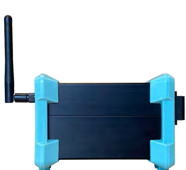
dydaqmeas mit 8 analogen Eingängen, digitalen I/O und leistungsfähigem ARM® Prozessor
