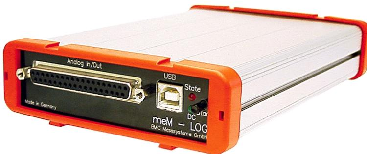
Mit dem Datenlogger **meM-LOG** bietet BMC Messsysteme GmbH in seiner Produktpalette ein Messsystem an, das vielen messtechnischen Anwendungen völlig neue Möglichkeiten eröffnet. Es handelt sich dabei um ein vollständig autarkes Gerät, das insbesondere für Langzeitmessungen geeignet ist. Im Gegensatz zu einem klassischen Datenlogger, der Aufzeichnungen zwar dauerhaft aber nur sehr langsam vornehmen kann, erreicht **meM-LOG**
