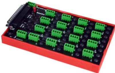
Über ein 37-poliges Verlängerungskabel (ZUKA37SB) kann der Adapter an die analoge bmc Messhardware angeschlossen werden.
