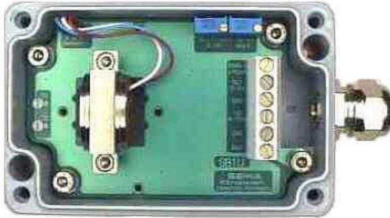
**Sensorbox mit einem Sensor und einem Spannungsnormierverstärker mit 0 bis 5Volt Signalausgang**
