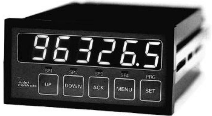
**Modell OC 7510** ist eine 6-stellige programmierbare Fernanzeige mit Kontrollfunktionen. Sie ist zum direkten Anschluss an RS232, RS422 oder RS485 Schnittstellen bestimmt. Das Datenformat besteht aus 8 Datenbit, ohne Parität, 1 Start- und 1 Stopbit, 1200 bis 19200 Baud. Die RS422 und RS485 Schnittstellen haben wählbare Adressen von 1 bis 31.
