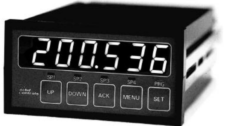
**Orbit Controls OC7056** ist ein programmierbares 6-stelliges Messgerät mit 200 000 echten Messpunkten. Es ist vorwiegend zum Anschliessen von DC mV-Signalen, DMS-Brücken, Wägezellen und 4-20mA Stromschleifen. Eine lineare Übertragungseigenschaft mit direkter Zuordnung des Eingangssignal zum gewünschten Anzeigewert steht zur Verfügung.
