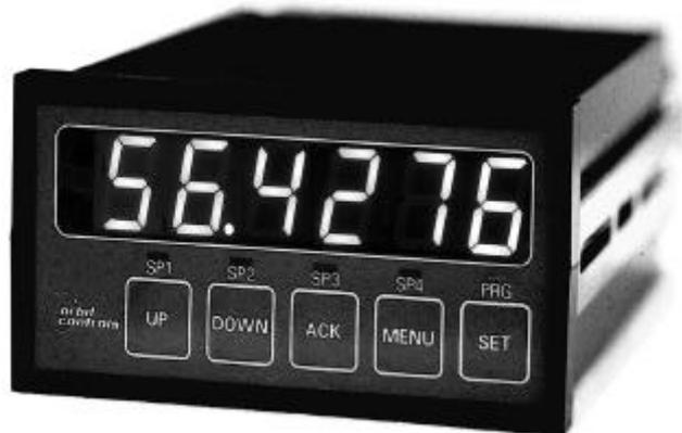
**Orbit Controls OC7040TAB** ist ein programmierbares 6-stelliges Messgerät mit 100000 Messpunkten und wählbaren Eingängen für lineare und nicht lineare Prozesssignale. Lineare Signalquellen werden in zwei Punkten kalibriert. Nicht lineare Sensoren können in bis zu 19 Punkten über die Tastatur linearisiert werden. Das Sensorsignal wird gemessen und am Display angezeigt. Über die Tastatur können die Anzeigewerte frei modifiziert und dadurch die Unlinearität korrigiert werden.
