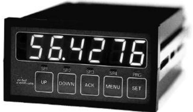
**Modell OC7015** ist ein 6-stelliger programmierbarer Prozesskontroller - Linearisator mit  $\pm 100000$  echten Messpunkten. Prozeßsignale aus DMS- Brücken mit Strom- oder Spannungsversorgung sowie Pt-100 und J,K,E,S,B,T und C DIN-Thermoelemente mit interner oder externer Kaltstellekompensation können direkt angeschlossen und verarbeitet werden.
