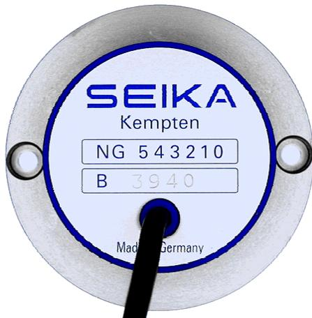
Neigungssensoren mit hoher Messgenauigkeit und integriertem 4 bis 20 mA Stromnormierverstärker zur Neigungsmessung in den Messbereichen  $\pm 10$ ,  $\pm 30$  und  $\pm 80$  Grad
