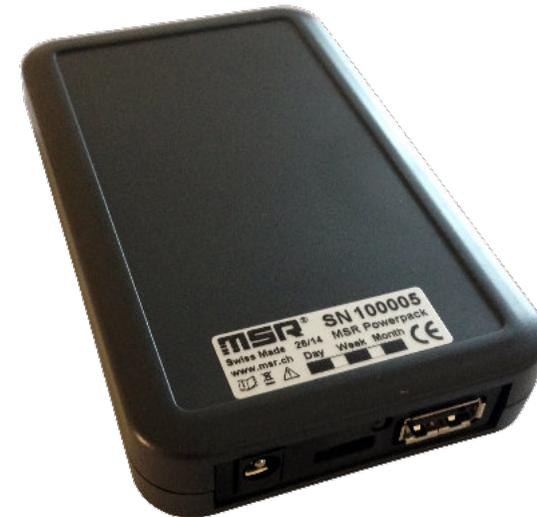
Das MSR Power Pack ist eine autonome Ladestation, die den internen Akku eines MSR Datenloggers während des Betriebs nachladen kann. Dank der Kapazität von 5000 mAh und einem einstellbaren Lade-Intervall von einem Tag, einer Woche oder einem Monat können wesentlich längere Messaufgaben realisiert werden. So kann damit z.B. ein MSR165 Datenlogger bis zu 6-mal länger Daten aufzeichnen.
