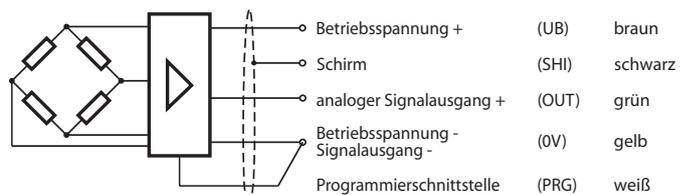
Drucklast ist positive Signalverstärkung.
