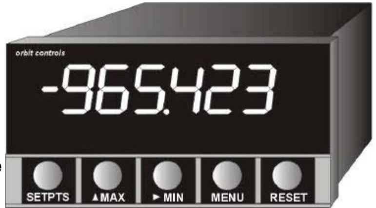
**Modell INF&ABS** ein 6-stelliger Zähler zum Anschluss an absolutkodierte Drehgeber mit parallelen oder seriellen Daten, Gray- oder binär kodiert. Das Gerät ist vorwiegend für industrielle Anwendungen konzipiert, in welchen präzises Positionieren oder Winkelmessung verlangt wird. Es können Single Turn oder Multi Turn Drehgeber mit bis zu 32 bit seriellen SSI, EnDat oder RS485 Daten oder bis zu 14 bit parallelen Daten angeschlossen und ausgewertet werden.
