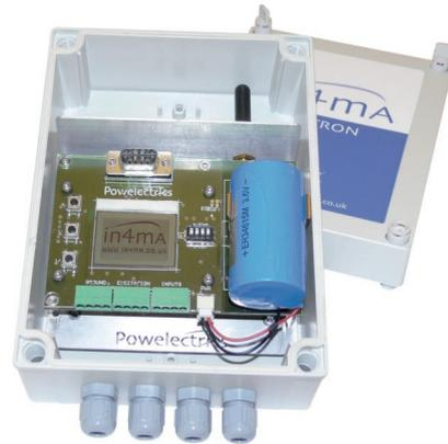
Der IN4MA-Metron ist eine batteriebetriebene, fernprogrammierbare SMS-Telemetrieinheit mit vier Eingängen (als Analog- oder Digitaleingänge konfigurierbar), der Ihnen Warnmeldungen oder in regelmäßigen Abständen Berichte in SMS-Form direkt an Ihr Handy oder an einen zentralen Server schicken kann.
