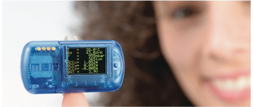
**WLAN-Datenlogger zur Überwachung von Temperatur, Feuchte, Luftdruck, Flüssigkeitsdruck, Licht, 3-Achsen-Beschleunigung, Dehnungsmessstreifen u.v.m.**
