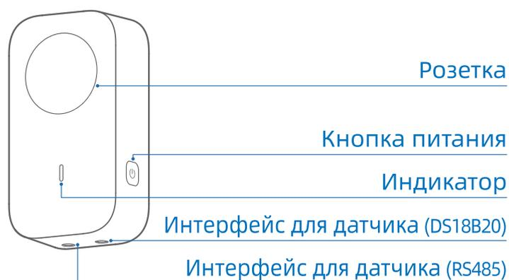
Примечание: Интерфейс датчика - аудиоразъём 3,5 мм.
