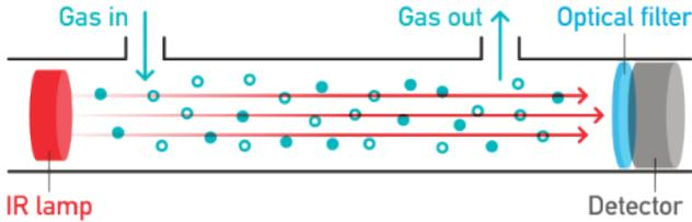
Aranet4 verwendet einen nicht dispersiven Infrarot-Sensor (NDIR) zur Messung der CO<sub>2</sub>-Konzentration. Das CO<sub>2</sub>-Gas in der Kammer absorbiert Infrarotlicht, und diese Absorption wird durch den Sensor gemessen. Je weniger Licht durchdringt desto höher ist die CO<sub>2</sub>-Konzentration. Da das CO<sub>2</sub>-Gas nur eine bestimmte Wellenlänge des Lichts absorbiert, wird ein optischer Filter verwendet.
