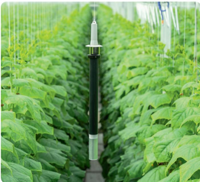
Aranet T/RH-Sensor mit Konvektions-Strahlungsschutz
