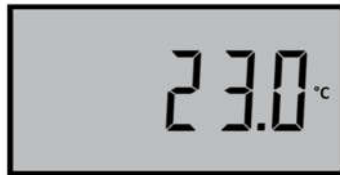
Logger wartet auf den START Drücken Sie die START-Taste für 5 Sekunden, um den Logger zu starten
