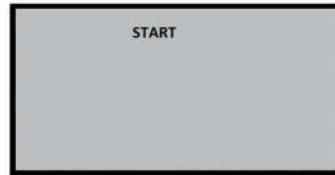
Logger ist gestartet Der Logger wartet bis Startzeit der Verzögerung beendet ist.
